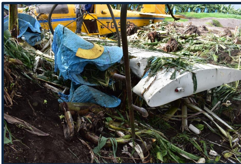
Fotografía No. 13 Vista de daños en el ala izquierda.
