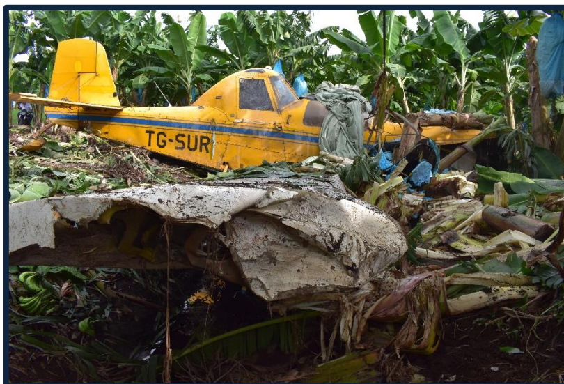
Fotografía No. 14 Vista de daños en el ala derecha.
