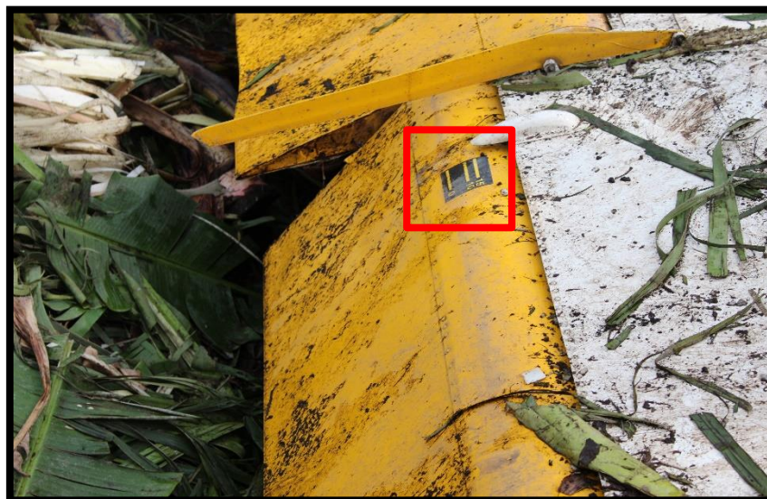
Fotografía No. 12 Vista lateral de la marca de extensión completa de los flaps.
