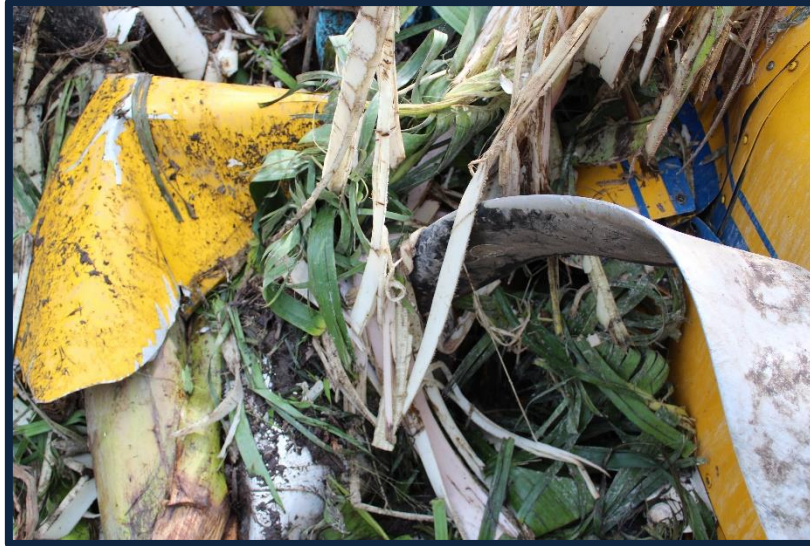
Fotografía No. 09 Vista lateral del daño en el asa de la hélice.
