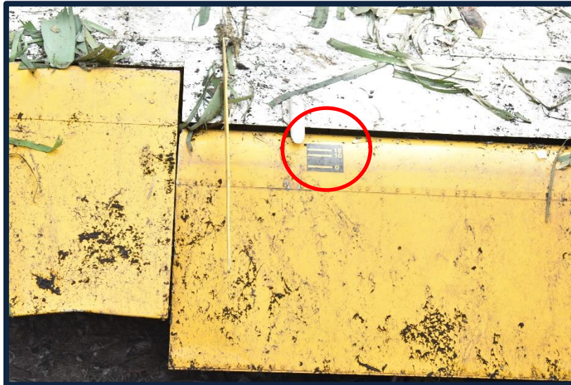
Fotografía No. 05 Vista de los flaps del lado izquierdo y la marca de extensión.
