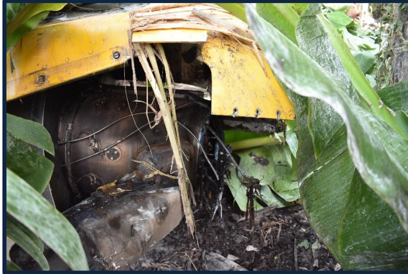
Fotografía No. 11 Vista de daño en el motor, parte frontal desprendida.
